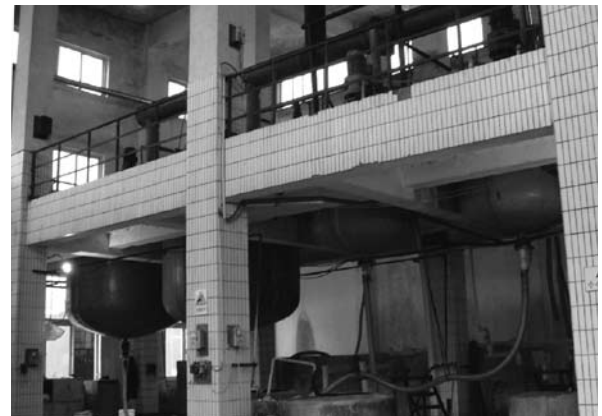
写真4 沈殿分別と溶解槽の工程
