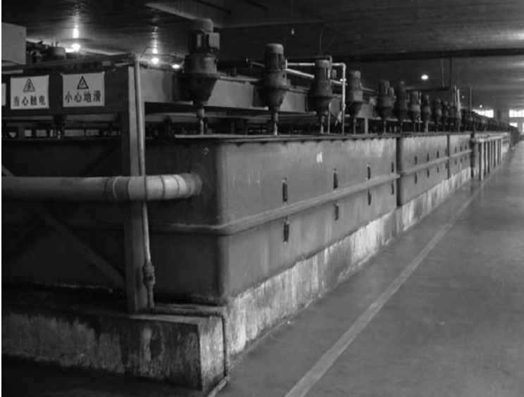
写真2 溶媒抽出工程（ミキサーセトラーのライン）
